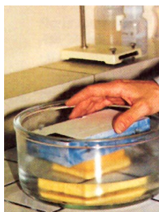
Test przepuszczalności wody w pomieszczeniu klimatyzującym do 23°C i przy 50% wilgotności względnej.
