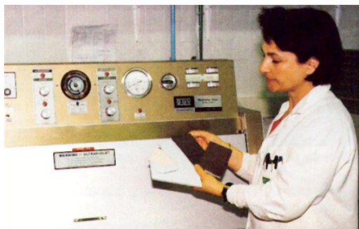
Test starzenia się w przyspieszeniu na maszynie sprawdzającej odporność na promieniowania UV.
